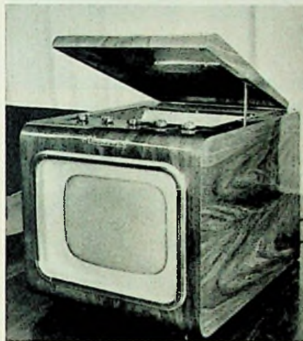
Zwei Beispiele aus der Empfängerproduktion der UdSSR: Phonosuper „Minsk R 7“, ein 7-Röhren-Super, und der Fernempfänger „Avantgard“
