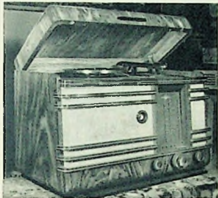
Zwei Beispiele aus der Empfängerproduktion der UdSSR: Phonosuper „Minsk R 7“, ein 7-Röhren-Super, und der Fernempfänger „Avantgard“
